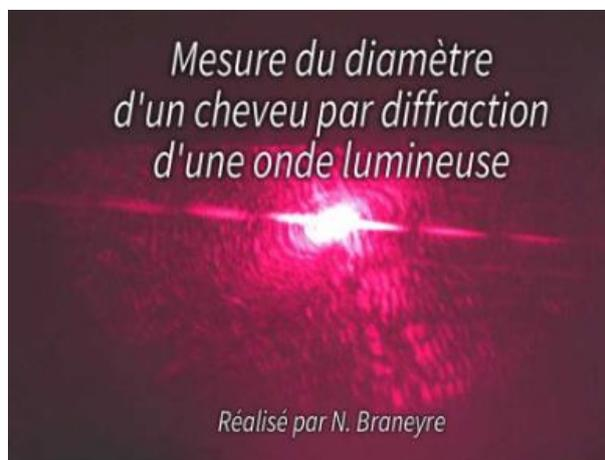
Ci-contre la figure de diffraction d'un laser qui frappe un cheveu placé verticalement, la figure de diffraction est alors horizontale.
