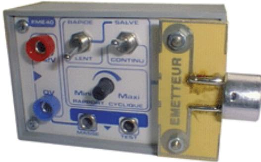
Le générateur d'ultrasons électrome émet une onde mécanique de la même famille que le son mais dont la fréquence est supérieure à 20 000 Hz.
