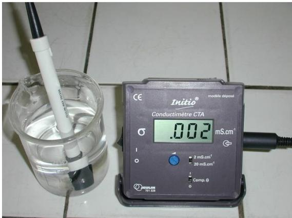
Le conductimètre est un appareil qui permet de mesurer la conductivité d'une solution ionique.
